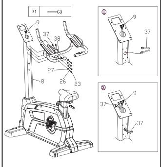
Schritt 4 Die Lenkersäule am Rahmen montieren. Die Schrauben aus der Verbindung zwischen dem Rahmen und der Lenkersäule schrauben. Die obere Abdeckung (21) auf die Lenkersäule setzen.
